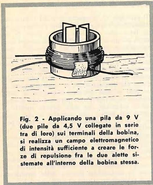
**Fig. 2 - Applicando una pila da 9 V (due pile da 4,5 V collegate in serie tra di loro) sui terminali della bobina, si realizza un campo elettromagnetico di intensità sufficiente a creare le forze di repulsione fra le due alette sistemate all'interno della bobina stessa.**
